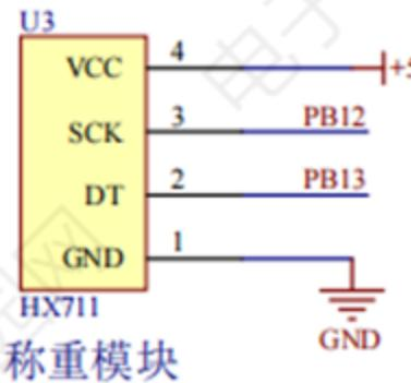
在基于单片机的厨房烘焙高精度称量装置中，HX711作为高精度24位模数转换器（ADC），主要功能是将称重传感器的模拟信号转换为数字信号，供单片机读取和处理。其高精度特性确保了食材称量的准确性，同时支持多种增益选择，可适应不同量程的称重需求。此外，HX711还具备低功耗和自动功率关闭功能，适合厨房烘焙等长时间使用场景。
