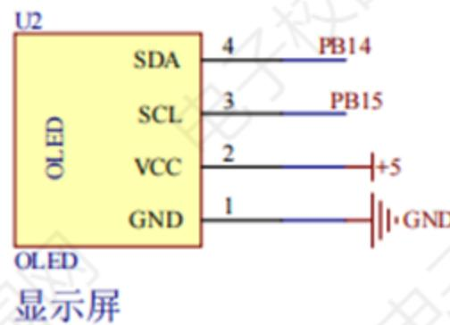
在基于单片机的厨房烘焙高精度称量装置中，OLED显示屏的主要功能是清晰、直观地显示称量结果。它能够以数字形式实时展示食材的重量，并支持多种重量单位的切换显示，如克、磅、盎司等。OLED显示屏还具有高亮度、广视角和快速响应时间等特点，即使在厨房光线较强或不同角度下，用户也能轻松读取称量数据。
