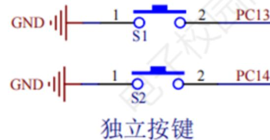
在基于单片机的厨房烘焙高精度称量装置中，独立按键的主要功能是提供用户交互界面，用于切换重量单位、启动称量、校准装置等操作。每个按键对应特定的功能，用户只需简单按下即可实现所需操作，提高了装置的易用性和灵活性。独立按键设计使得用户操作更加直观，提升了厨房烘焙称量体验。
