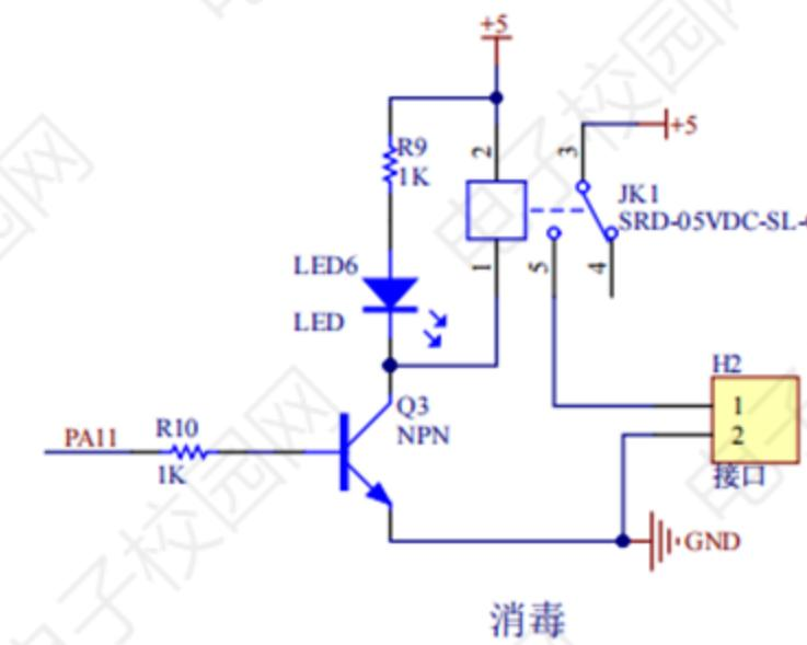
基于单片机的智能奶瓶消毒模块，主要功能是利用紫外线LED灯（通过继电器控制）对奶瓶进行高效消毒。该模块通过单片机控制紫外线灯的开关和工作时间，确保消毒过程的安全性和有效性。同时，结合温度传感器，实时监测奶瓶温度，避免高温对奶瓶材质的损害，保障消毒质量。
