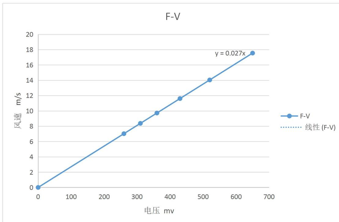
风速传感器输出电压信号与风速的计算公式如下：
