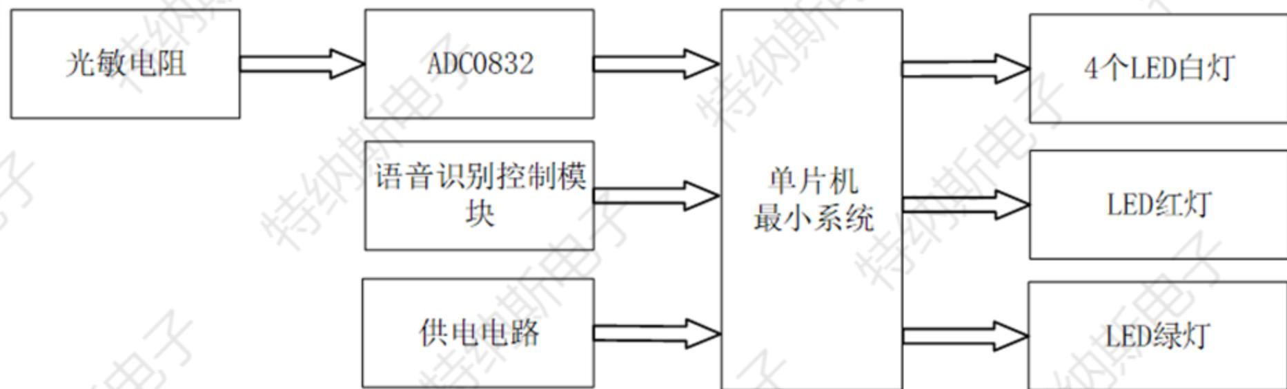
输入：光敏电阻、语音识别控制模块、供电电路等
