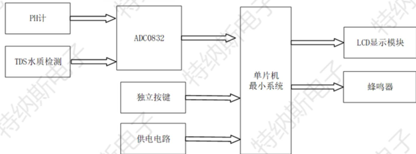
输入：PH计、TDS水质检测模块、独立按键、供电电路等
