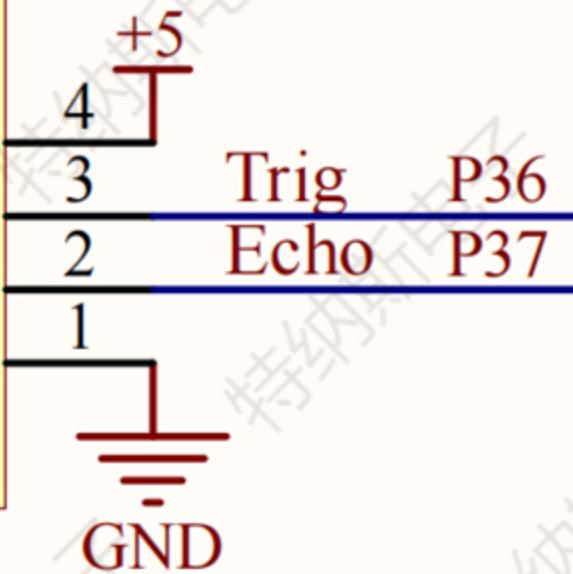
在基于单片机的智能垃圾桶设计中，超声波测距模块发挥着垃圾满载检测的关键作用。它通过发射超声波并接收反射波来计算垃圾桶内垃圾的高度，从而判断垃圾桶是否满载。当垃圾高度达到预设阈值时，模块会触发报警机制，如语音提示或发送短信通知管理人员。这一功能确保了垃圾桶在满载时能够及时得到清理，避免了垃圾溢出和环境污染。
