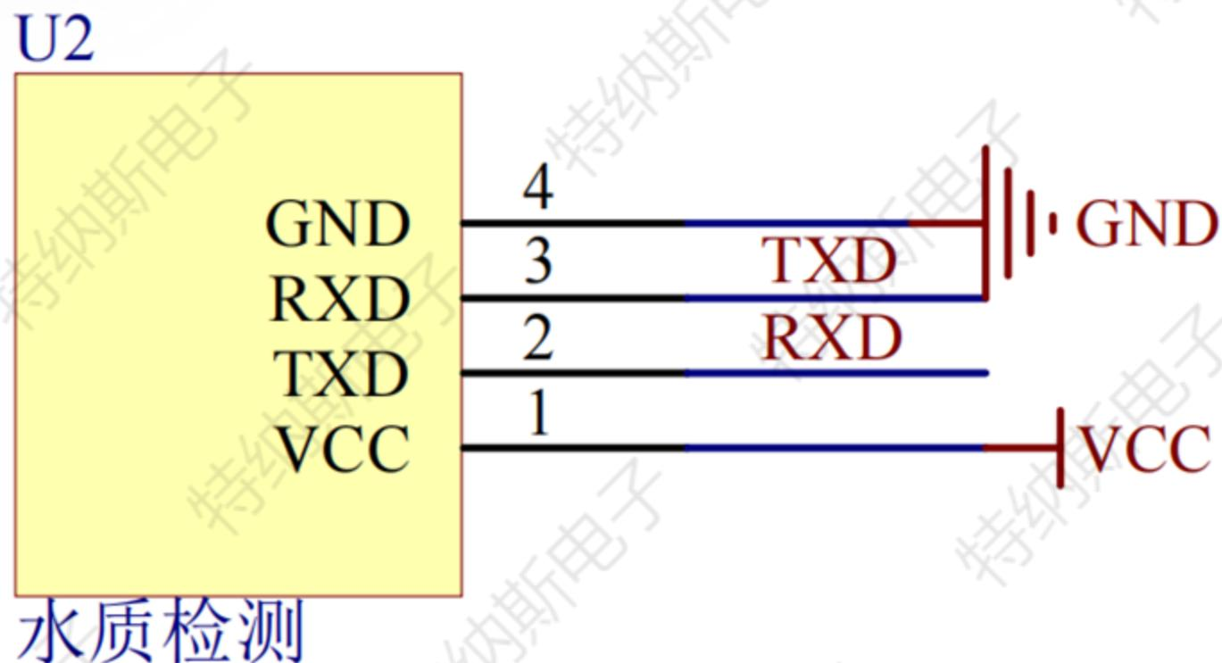
在基于51单片机的智能鱼缸系统中，水质检测模块的功能至关重要。该模块通过集成的水质传感器，实时监测鱼缸中的水质状况。当检测到水质参数（如TDS值）超过预设的阈值时，模块会自动触发换水功能，通过控制水泵等设备实现水质的改善，从而确保鱼缸内的水质始终保持在适宜鱼类生存的范围内。这一功能有效提升了鱼缸管理的智能化水平。
