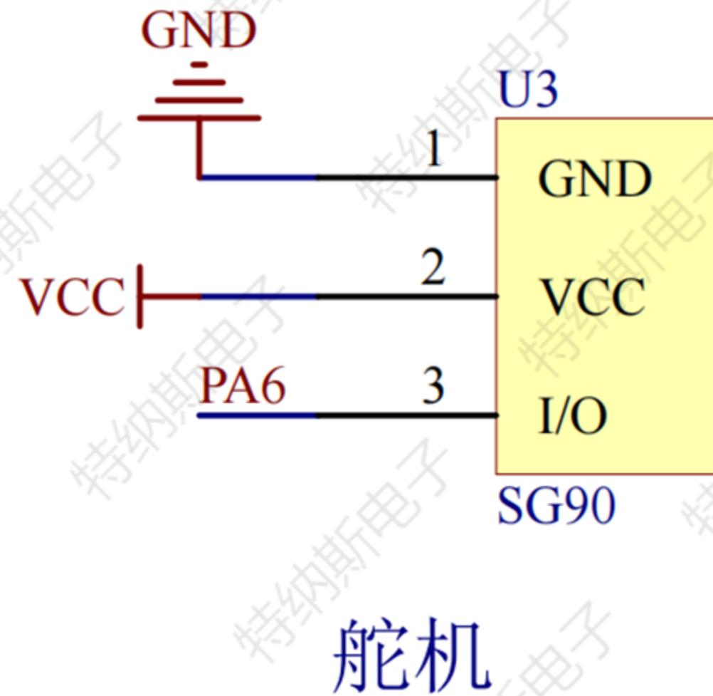
在基于STM32的智能RFID车位锁系统中，舵机模块扮演着执行器的关键角色。它根据STM32微控制器发送的控制指令，精确地控制车位锁的开启和关闭动作。当系统验证用户身份成功后，舵机模块会迅速响应，驱动车位锁的机械结构进行旋转，实现车位的解锁。这种设计不仅提高了车位锁的反应速度，还确保了车位使用的安全性和可靠性。
